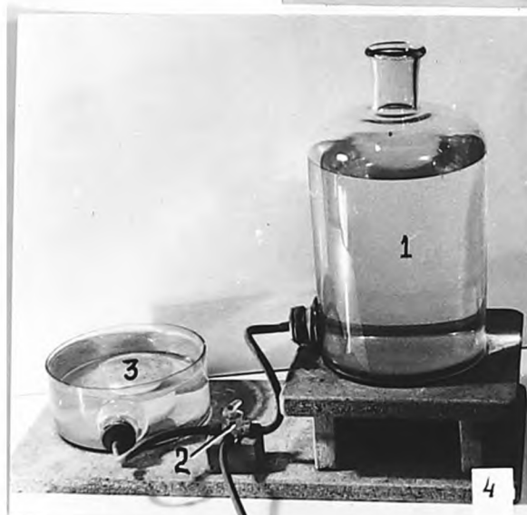
Рис. 3. Использование осветителя ОИ-21 с отраженным светом для проверки качества стеклянного ножа 1/ — стеклянный нож
