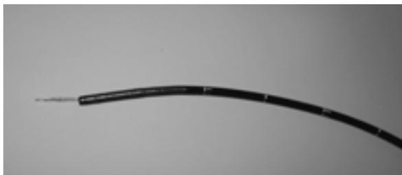
**Рис. 2. Подготовка минидачика к исследованию. Минидачик введен в тубус проводник, определена длина уровня выхода датчика.**
