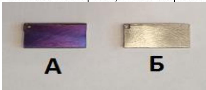
Рис.1 Титановые пластины с напылением алмазоподобного углеродного покрытия (А) и без покрытия (Б)
