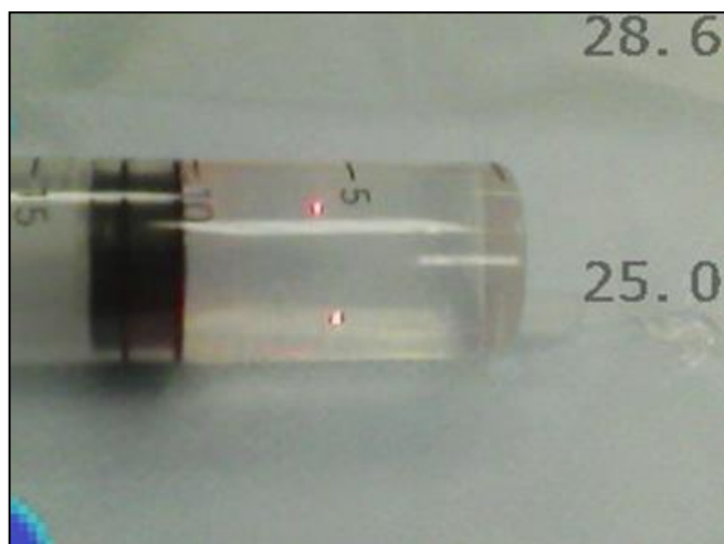
Рисунок 42 — Начало облучения раствора лидокаина в шприце. Температура в зоне измерения тепловизором — 28,6 °С, минимальная температура в зоне измерения — 25,0 °С
