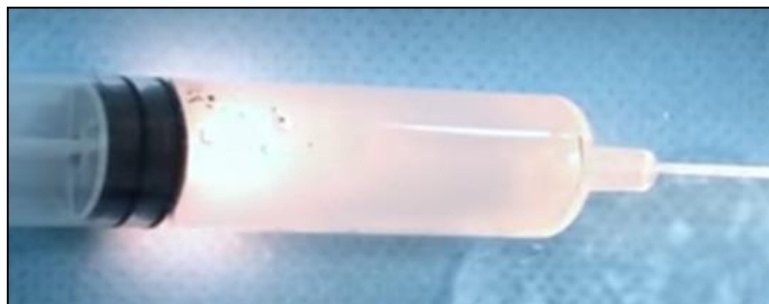
Рисунок 46 — Случайный контакт работающего конца с уплотнителем поршня. Видна яркая вспышка
