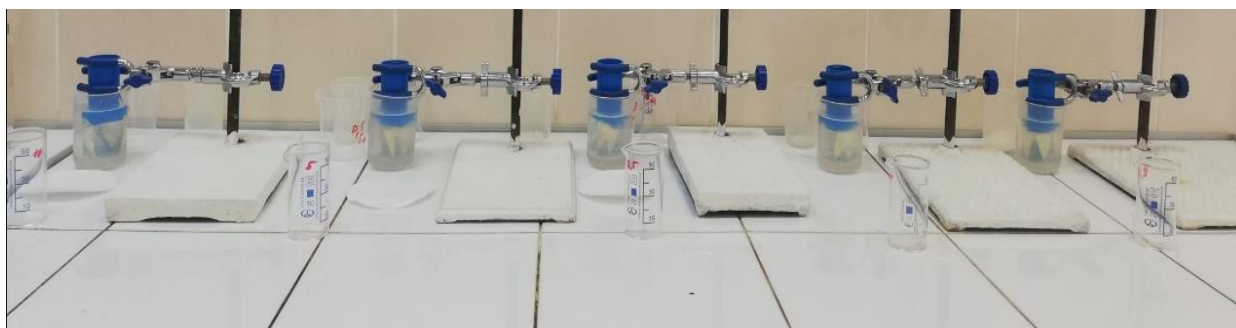
Рисунок 2.3. - Установки для экспериментальной оценки скорости диффузии через лецитиновый фильтр
