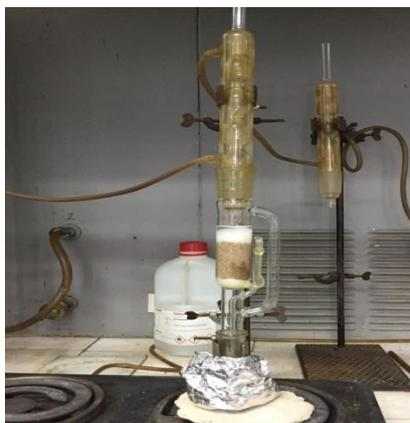
Рис. 1. Аппарат Сокслет для получения лигнаносодержащего экстракта из семян льна обыкновенного
