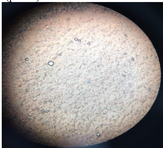
Рис. 1. Эмульсия под микроскопом (увеличение 100х)
