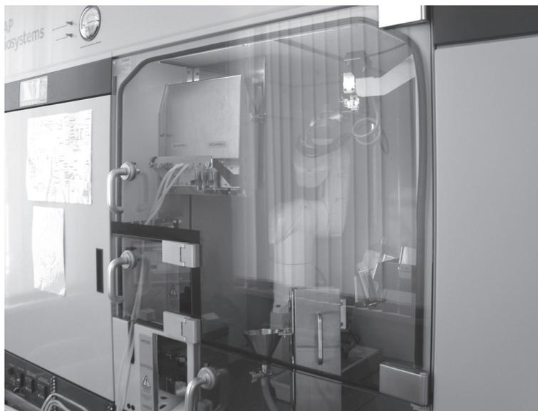
Рис. 1. Роботизированная станция CompaT Select для культивирования клеток.
