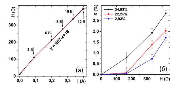
Рис. 1. Зависимость напряженности градиентного магнитного поля (H) в центре электромагнита от величины силы тока (I) в его катушке (a). Связь между напряженностью градиентного магнитного поля (H) и деформацией (ε) образцов с различной концентрацией магнитных наночастиц в феррогеле (δ).
