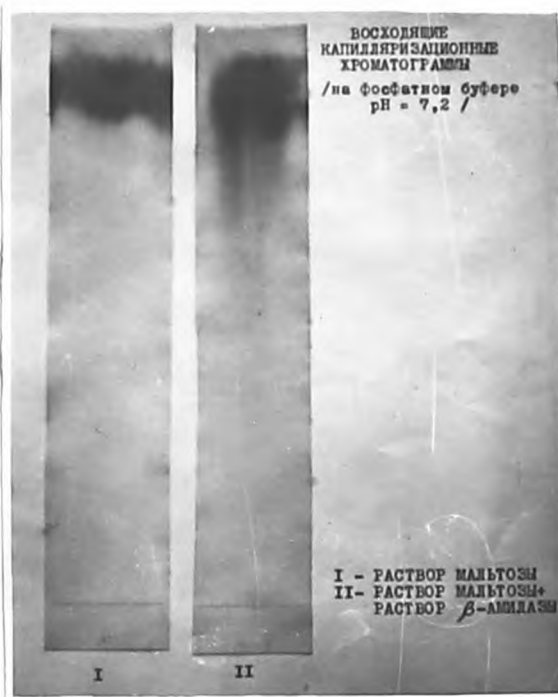
Рис. 1. Восходящие капилляризационные хроматограммы раствора мальтозы, содержащего 20 мг исследуемого вещества в 1 мл (I), и раствора мальтозы той же концентрации в присутствии бета-амилазы (II).
