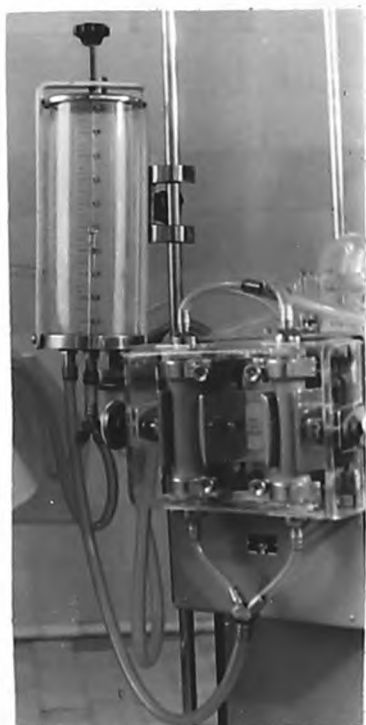
Рис.21. Общий вид системы "коронарного" отсоса после реконструкции.
