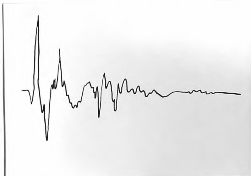
Рис.6 Разгон полотна косы. Осциллограмма вибрации с рукояток клещей. Скорость протяжки фотобумаги - 640 мм/сек
