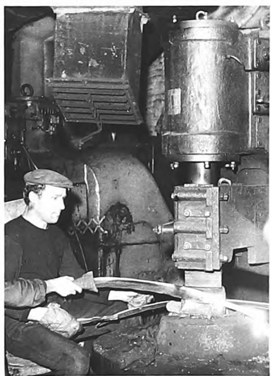
Рис.2. Разгон полотна косы на пневматическом молоте МСК-1 А
