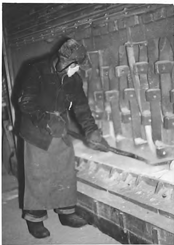
Рис.6- Загрузка графитового электрода в электролизёр с боковым подводом тока.
