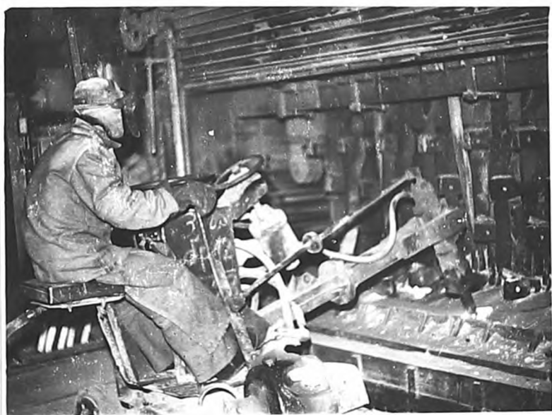
Рис. 4. Пробивка корки электролита с помощью самоходной пневматической машины.
