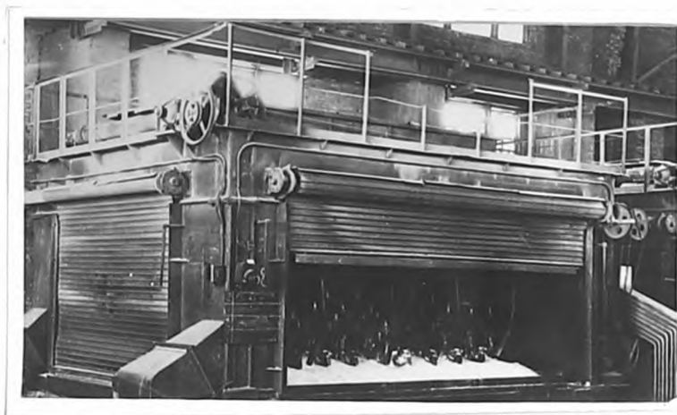
Рис. 2 - Электролизер с боковыми подводами газа к аноду.
