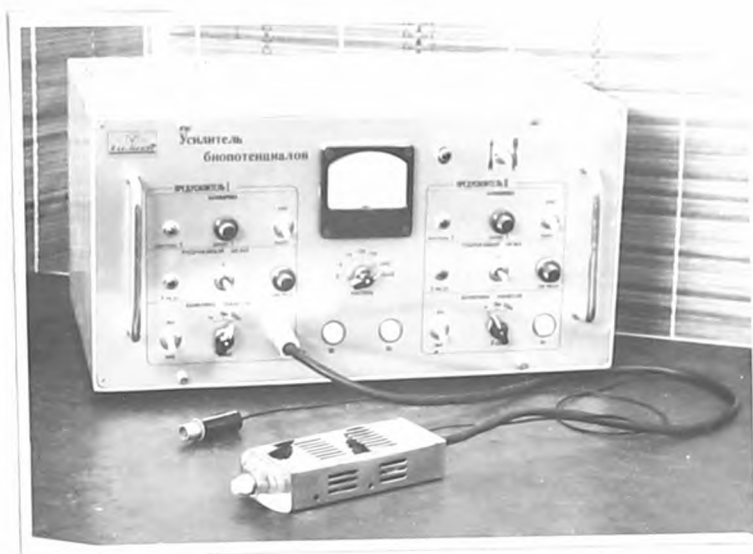
Рис.5. Внешний вид пульта управления катодного повторителя с блоком питания.
