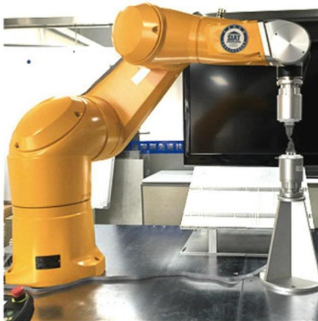
Рис.1. Новая роботизированная система для изгибания ортодонтических дуг.
