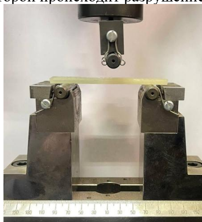
Рис. 2 Исследование образца пластины на изгиб
