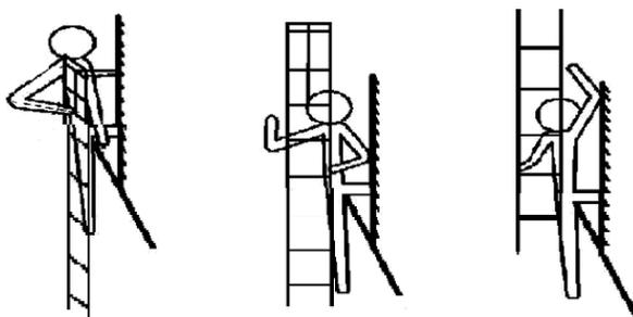
Рис. 2. Выброс штурмовой лестницы на вышерасположенный этаж
