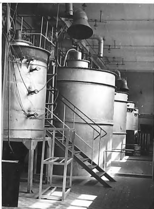
Рисунок 7. Печи для пирогенного синтеза асбеста и слюды.
