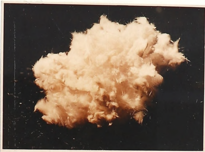
Рисунок 5. Никелевый торрихтерит. Срезанные волокна "петли". Образец получен О.Г.Чигаревой /1966/ ИХС АН СССР.
