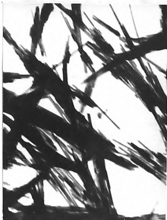
Рисунок 12. Волокна синтетического хризотил-асбеста (ИХС АН СССР) под электронным микроскопом \times 16000
