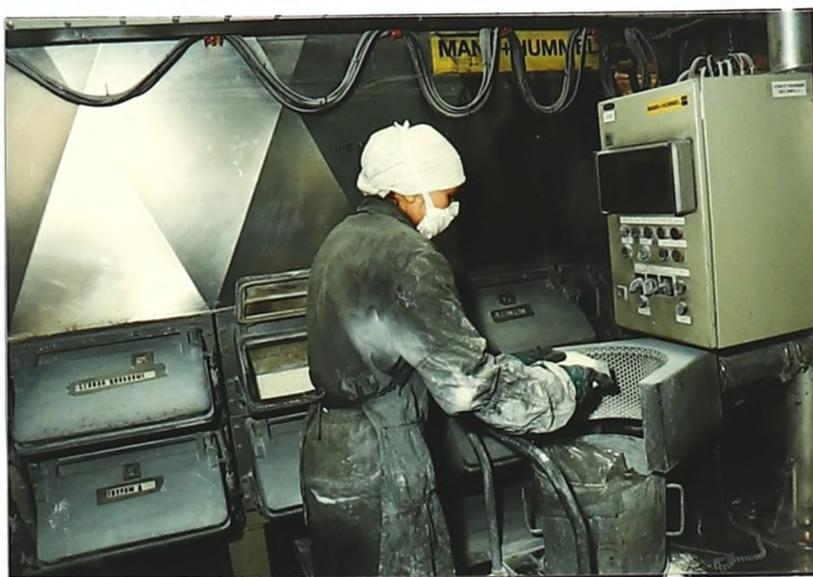
Рис. 3.3. Составитель навесок сыпучих ингредиентов – автоматическая линия дозирования
