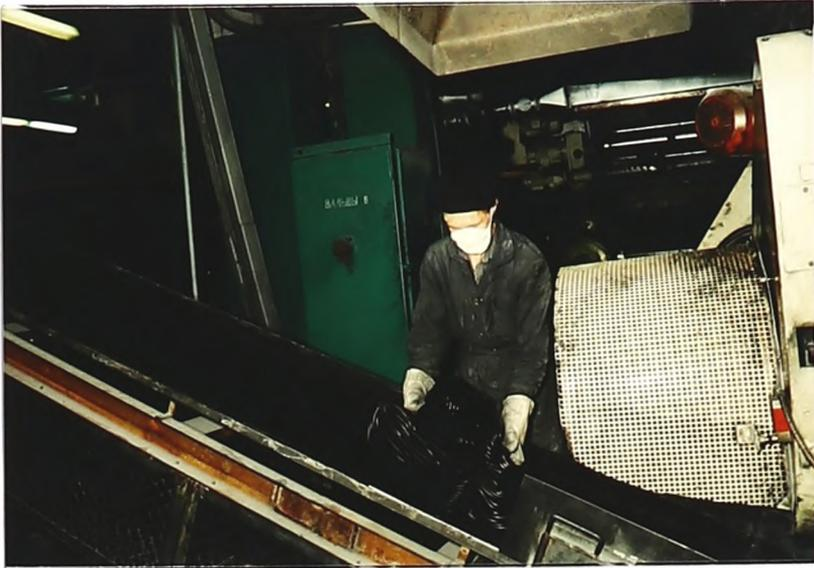
Рис. 3.1. Составитель навесок – подача каучука к распарочным камерам
