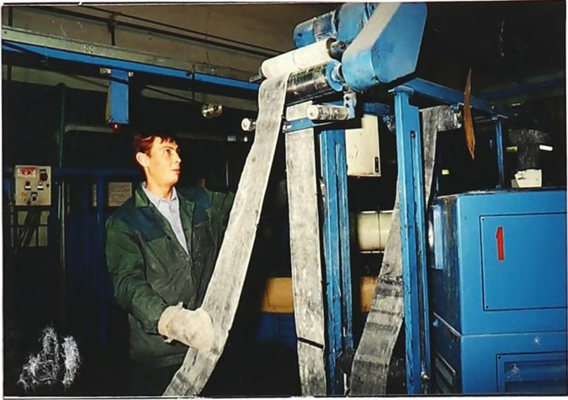
Рис. 3.7. Рабочее место оператора-вулканизаторщика на линии «Сайаг»
