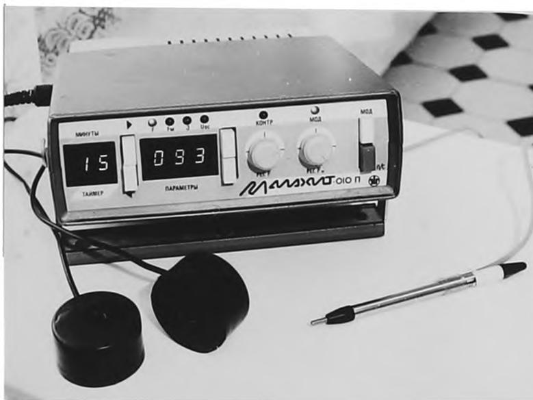
Рис.2.3. Внешний вид лечебно-диагностического комплекса “Малахит - 010П” с двумя подключенными стандартными индукторами-излучателями и диагностическим датчиком собственной конструкции.
