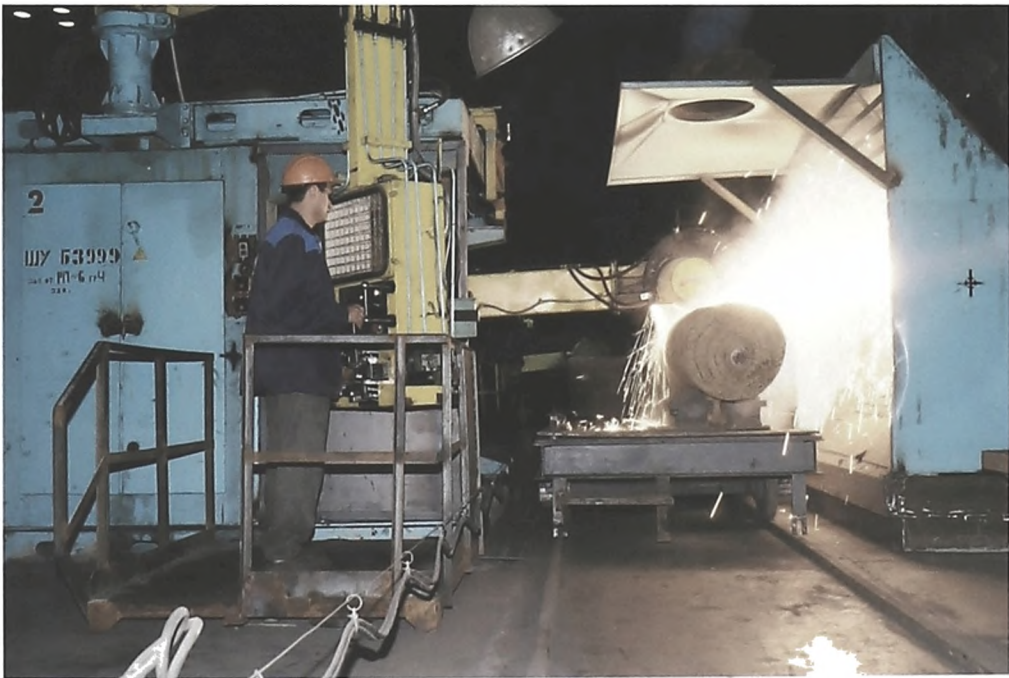
Рисунок 16. Рабочее место доводчика-притирщика. Пульта управления зачистным блоком стационарной зачистной машины абразивной зачистки сухим способом.
