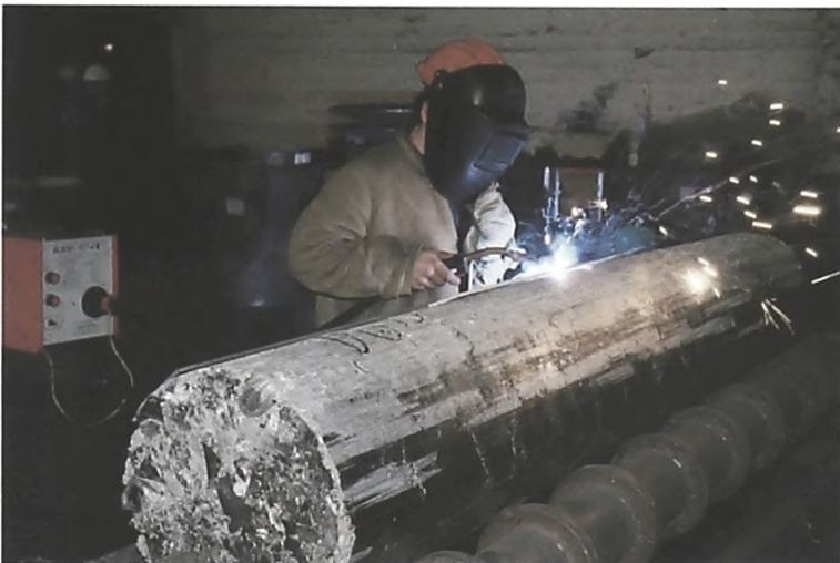
Рисунок 14. Рабочее место электрогазосварщика. Обварка титановыми полосами прессованных электродов методом аргоно-дуговой сварки.
