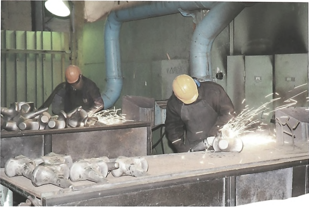
Рисунок 15. Рабочее место доводчика-притирщика. Зачистка поверхности титановых изделий ручными пневматическими шлифовальными машинами.
