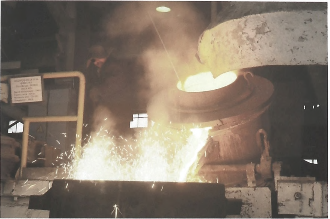
Рисунок 1. Рабочее место плавильщика. Плавка ферротитана в индукционных канальных печах «АЯКС». Слив металла.
