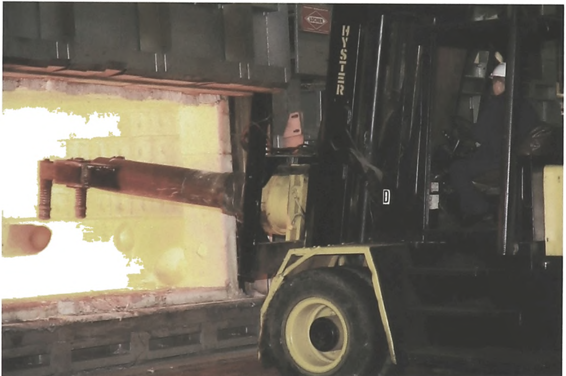
Рисунок 8. Кузнец-водитель погрузчика при выгрузке титанового слитка из газовой печи нагрева.
