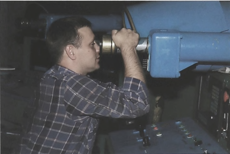
Рисунок 2. Рабочее место плавильщика. Вакуумно-дуговая печь. Пультовая. Наблюдение за процессом плавки в перископ.
