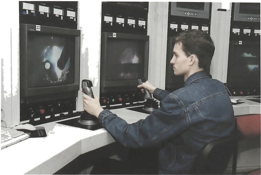
Рисунок 3. Рабочее место инженера-электроника по управлению процессом плазменно-подовой плавки. Пультовая.
