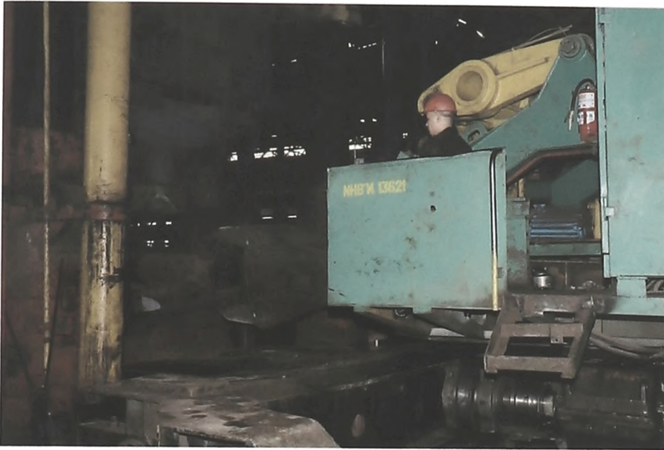
Рисунок 7. Кузнец-оператор шаржир-машины задает заготовку в зону обработки прессы.
