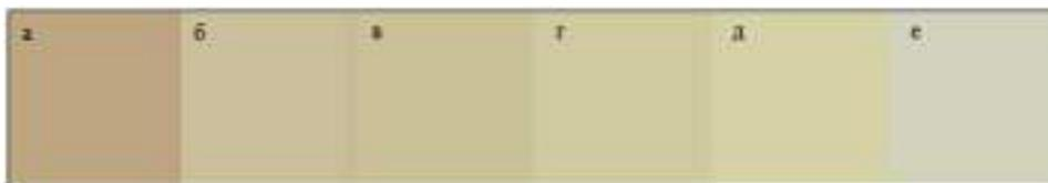
Рис.2 Выделение среднего цвета изображения: а – 135 мМ раствор  $C_6H_{12}O_6$ ; б – 90 мМ раствор  $C_6H_{12}O_6$ ; в – 30 мМ раствор  $C_6H_{12}O_6$ ; г – 45 мМ раствор  $C_6H_{12}O_6$ ; д – 54 мМ раствор  $C_6H_{12}O_6$ ; е – до добавления раствора  $C_6H_{12}O_6$
