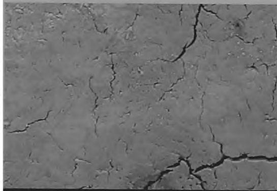
Рис. 3 Поверхность образца после обработки магнитостриктивным ультразвуком. СЭМ. Ув. 500.
