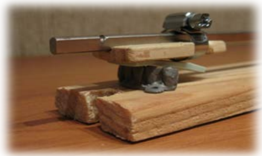
Конструкция в сборе: Силиконовая пластинка находится между рычагом и блоком зубов
