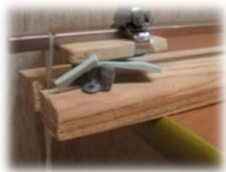
От приложенной силы силиконовая пластинка раскусилась
