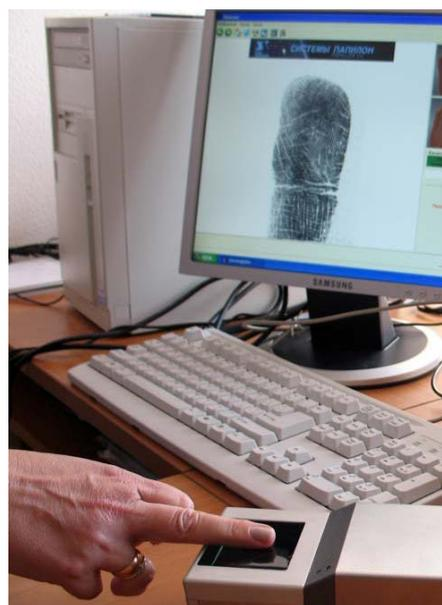
**Рис. 2.3.** Сканирование пальцевых узоров с помощью ДС-22
