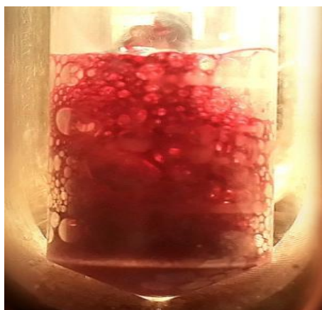
Рисунок 23 - Вспенивание суспензии Эр на этапе деконсервации
