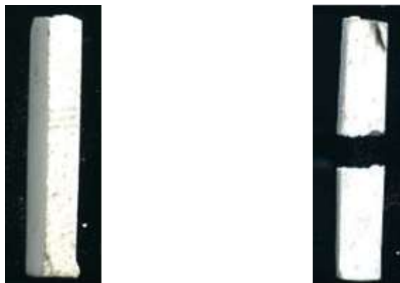
Рисунок 3.8 - Образец материала из диоксида алюминия до и после испытания на изгиб
