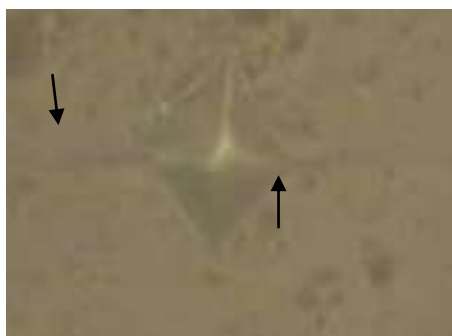
Рисунок 2.10 - Трещины в облицовочном слое, идущие от граней отпечатка индентора
