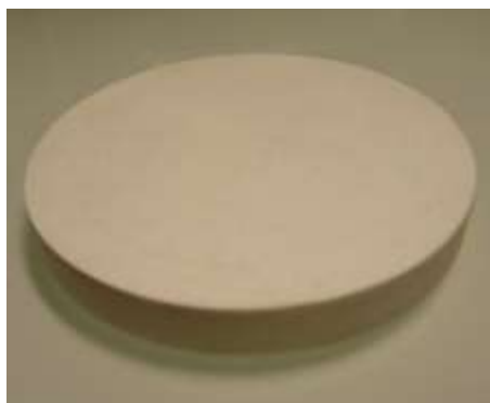
Рисунок 3.1 - Диск для фрезерования с помощью аппаратов CAD-CAM, изготовленный из керамики на основе оксида алюминия производства ЗАО «Уралинтех» D=98,5\text{мм} , h=12\text{мм} , вес 290г.
