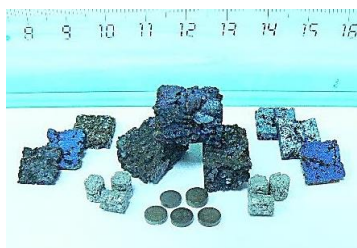
Рисунок 2.2.1 – Образцы титана пористого, полированного титана и пористые титановые имплантаты для испытаний in vitro и in vivo
