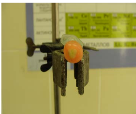
Рис. 12. Устройство для оценки скорости диффузии электролита через дентинные каналы с изоляцией
