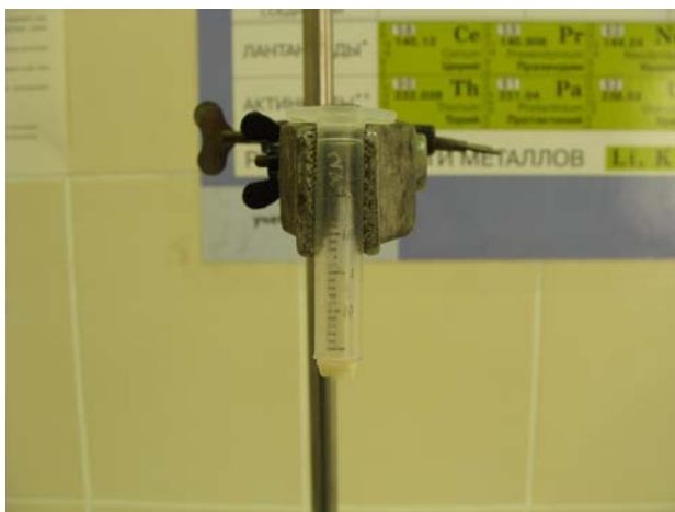
Рис. 13. Устройство для оценки скорости диффузии электролита через дентинные каналы без изоляции
