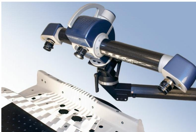
Рис. 8 – Оптическая измерительная система smartSCAN3D
