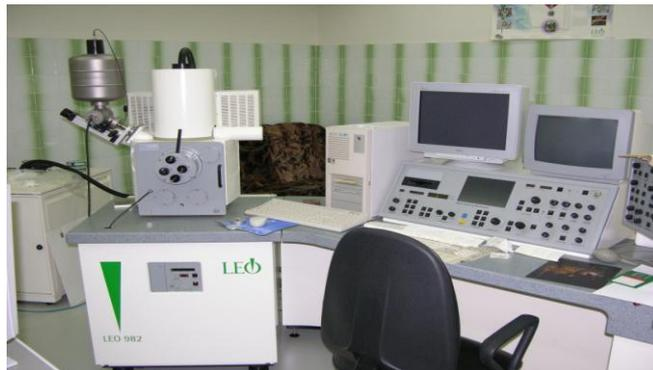
Рис.4. Растровый электронный микроскоп «LEO 982» фирмы Carl Zeiss, Германия
