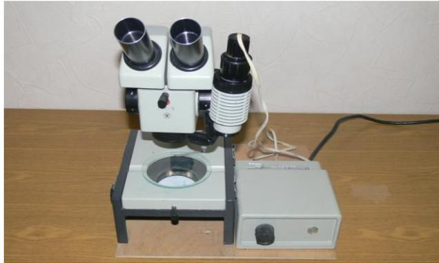
Рис.5. Поляризационный микроскоп МБС-9
