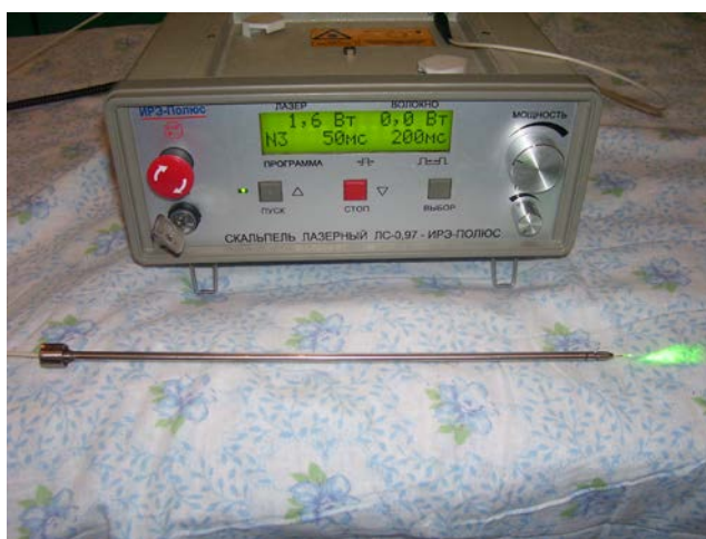
Рис. 1. Диодный лазер модели ЛС-0,97 - «ИРЭ-Полюс», длиной волны 970 нм с держателем световода.
