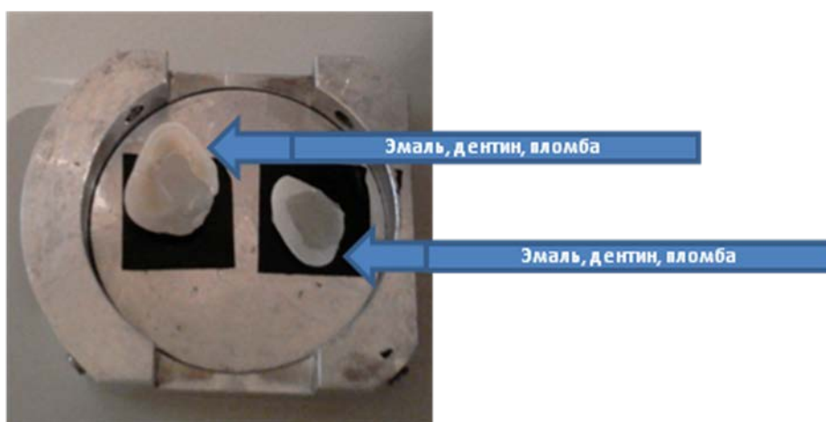
Рисунок 3.4. Подготовленные для исследования микроструктуры образцы - шлифы запломбированного зуба
