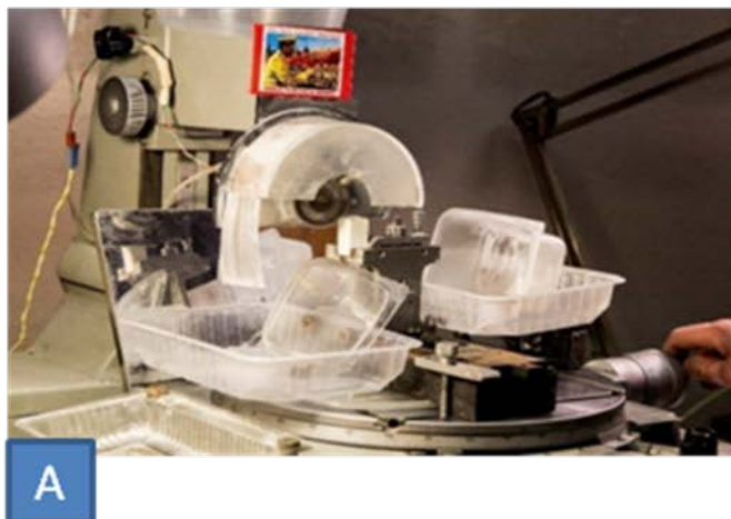
Рисунок 2.4. А - прибор для разрезания зубов на образцы для исследования; Б - схема резки коронковой части зуба на образцы
