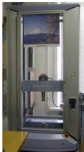
Рисунок 2.7. Испытательная машина Shimadzu™ AG-50KN - внешний вид
