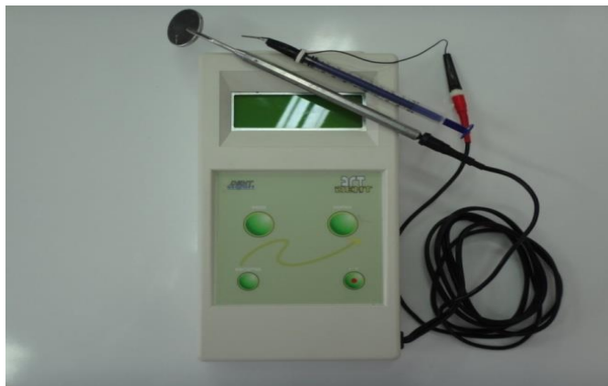
Рис.4. Электрометрический прибор «Дент-Эст»
