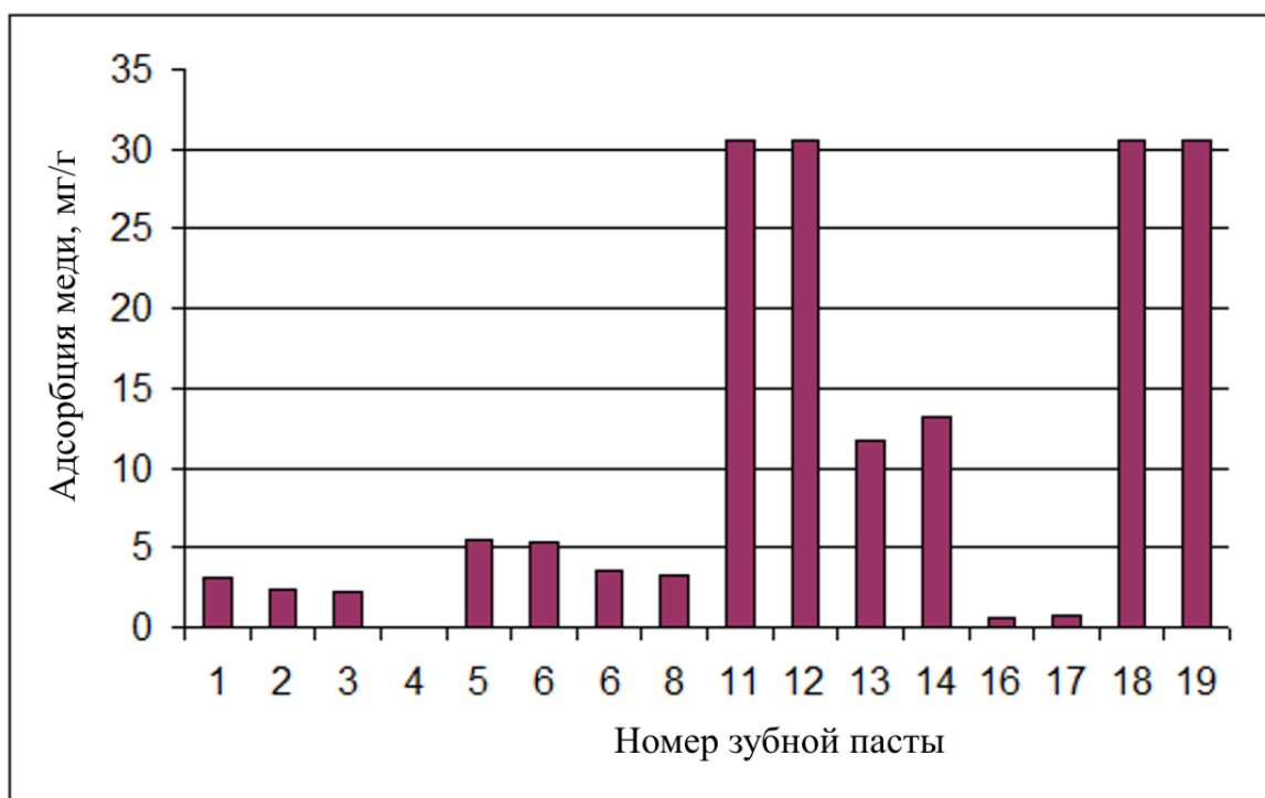
Рис. 16 Б. Степень адсорбции ионов меди(II) на твердом абразиве 1% суспензий ЗП, при концентрация меди(II) в исходном растворе — 305 мг/л
