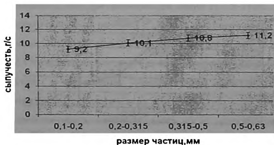
Рис.2. Зависимость сыпучести порошка Триазавирина от размера частиц.
