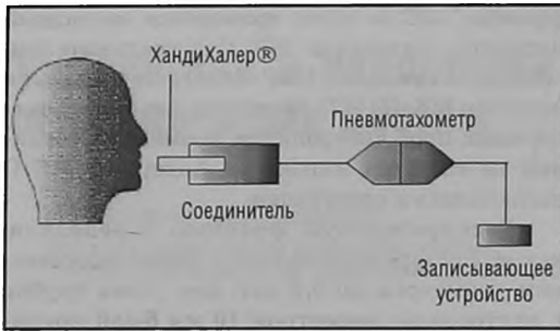
Рисунок 1. Схема соединения устройства и пневмотахометра
