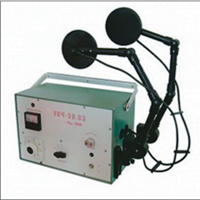
Рис. 61. Аппарат для УВЧ-терапии предназначен для местного лечебного воздействия электрическим или магнитным полем ультравысокой частоты
