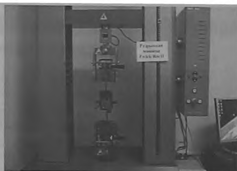
Рис. 5. Разрывная машина Zwick/Roell Z050 и экспериментальное приспособление
