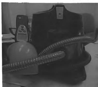
Рисунок 2. Измерительный блок для определения расхода воздуха, продуваемого через пылесос REINBOW D4
