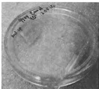
Рис. 1. Стерильный образец пластмассы «Фторакс» в чашке Петри для дальнейшего культивирования
