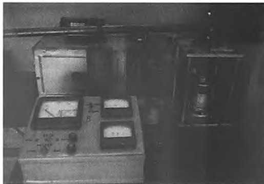
Рисунок 1. Схема работы (а) и общий вид (б) одношарикового адгезиометра: 1 – головка эндопротеза; 2 – образцы вкладыша; 3 – диск; 4 – тросиком для вращения головки
