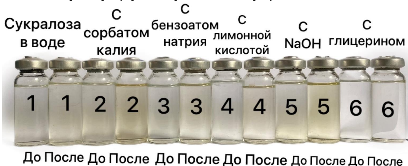
Рис. 1 Внешний вид флаконов до и после 30 дней термостат 45°C
