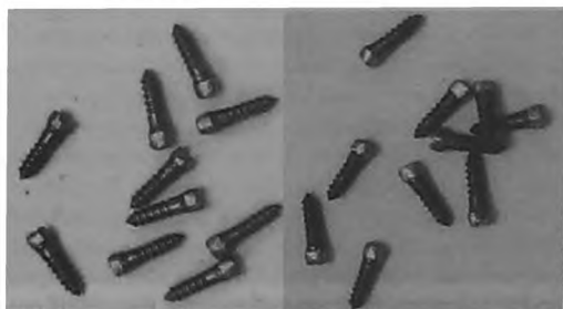
Рисунок 1. а) контрольные образцы из сплава титана BT5Л; б) экспериментальные образцы из сплава титана BT5Л с наномодифицированной поверхностью диоксидом титана.
