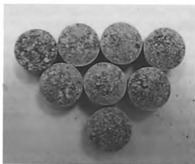
Рис. 3. Таблетки с МЦ, полученные с помощью влажного гранулирования
