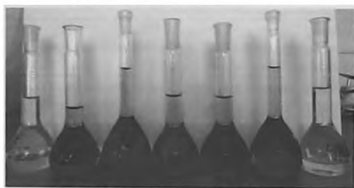
Рис. 8. Реакция с резорцином при спектрофотометрическом определении полисахаридов (инулина)
