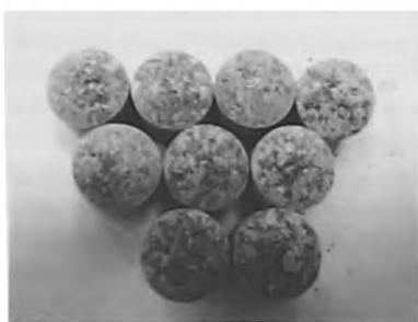
Рис. 2. Таблетки с Na-КМЦ, полученные с помощью влажного гранулирования
